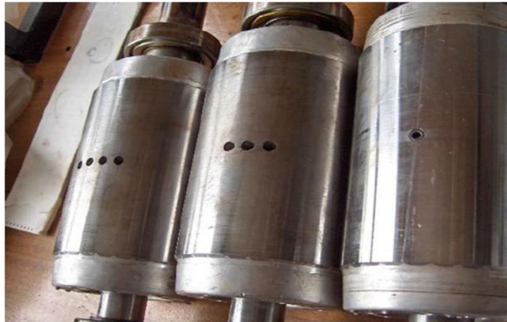
Figure 1.5 : Défaut de rupture de barres.
